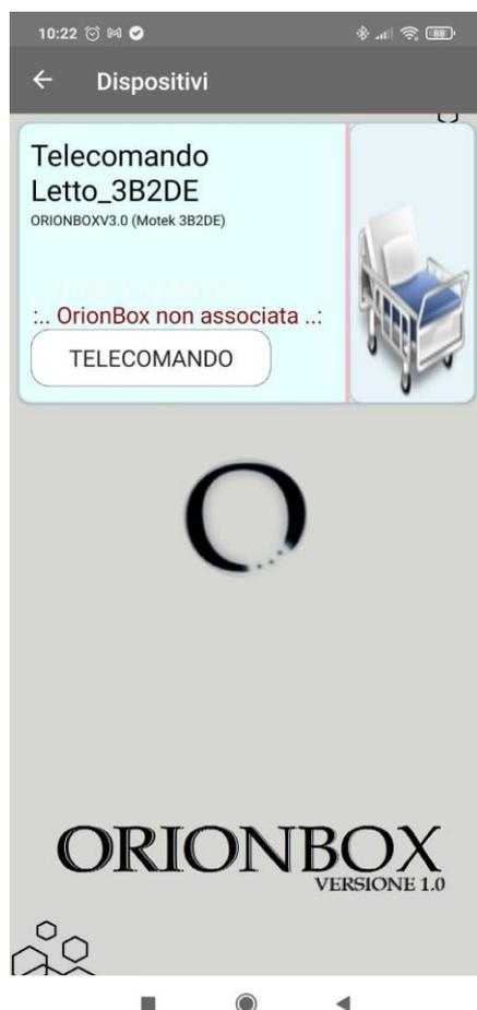
L'App ci indica che la configurazione è stata correttamente caricata, ora bisogna associare la Orion Box per il suo reale utilizzo. La prima volta che si apre il telecomando l'app effettua in automatico una scansione della rete WiFi alla quale è associata alla ricerca della Orion Box.
